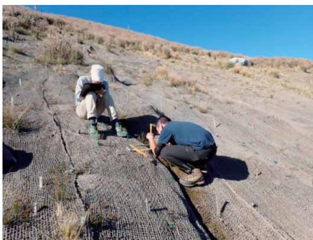
図 13 斜面下部で発達するガリー状の凹地。
