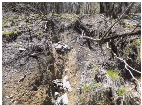
図4 泥質岩の分布地域における土壌の状況 粘性土層の硬質な岩片を多く含む.
